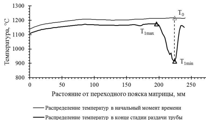
Рис. 2. Изменение температурного поля заготовки
